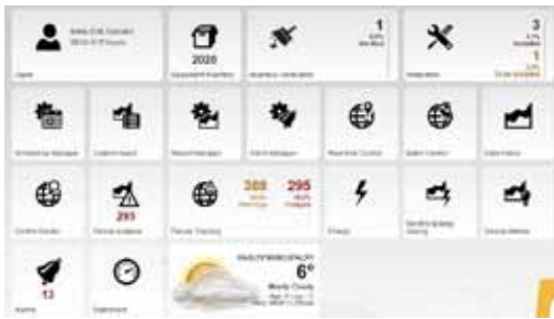
Figur 4. Lysstyring giver fuldt overblik og overvågning, hvor fejl og energiforbrug kan monitoreres i real-time.
