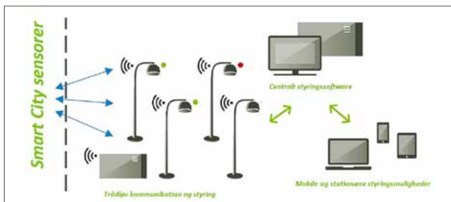
Figur 1. Princip for trådløs styring.
