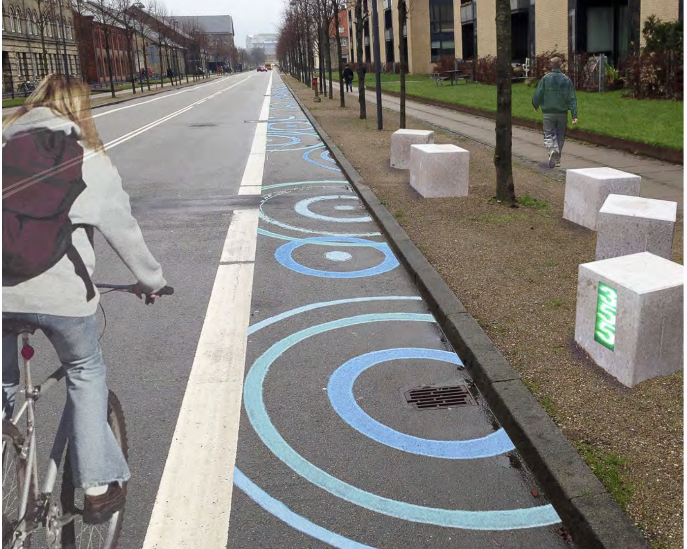
Figur 2. Vejbrønden integreres med overjordiske synlige elementer i form af en special vejrist, markeringer og farver i vejbelægningen eller en bænk, hvor mængden og kvaliteten synliggøres af det vand, der afkobles.
