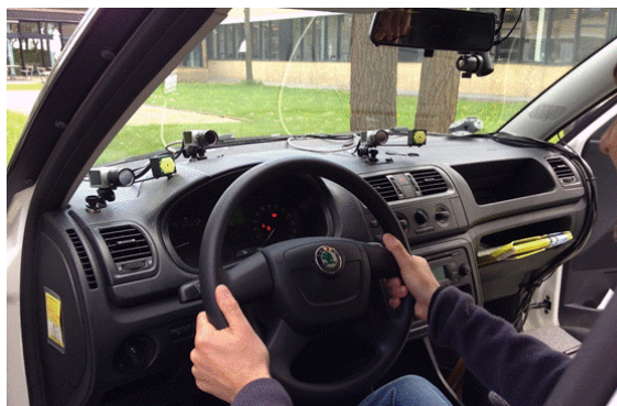
Figur 2. Kamerasystemet er monteret på bilens instrumentpanel og ved bakspejlet (foto t.v.). Bilisten er således helt fri og skal ikke bære noget af udstyret på sig. Laserscanner til måling af afstand er monteret på bilens frontpanel (foto t.h.)
